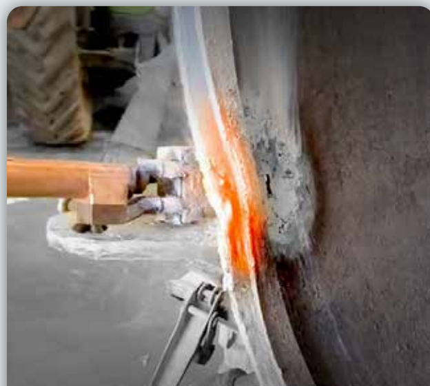
STRAIGHTENING MANURE TANK - REDRESSAGE CUVE À FUMIER Inductor L20/B4 Powerduction 110LG
