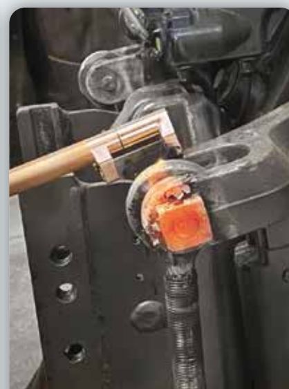
UNSEIZING LINKAGE ARMS - DÉGRIPPAGE BRAS DE RELEVAGE Inductor L90 Powerduction 160LG
