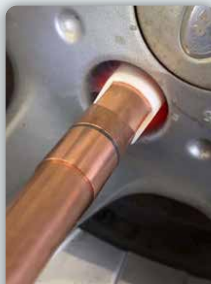
SEIZED WHEEL NUTS REMOVAL - DÉGRIPPAGE ÉCROUS DE ROUE Inductor S180/B3W Powerduction 37L
