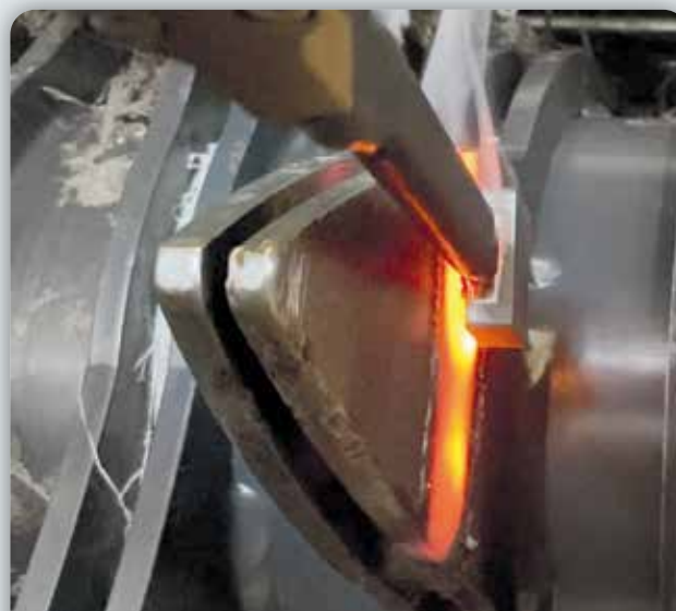
ROUND BALERS ROTOR TEETH STRAIGHTENING - REDRESSAGE DE DENTS DE ROTOR DE PRESSE À BALLES RONDES Inductor L-X1/B1 Powerduction 220LG
