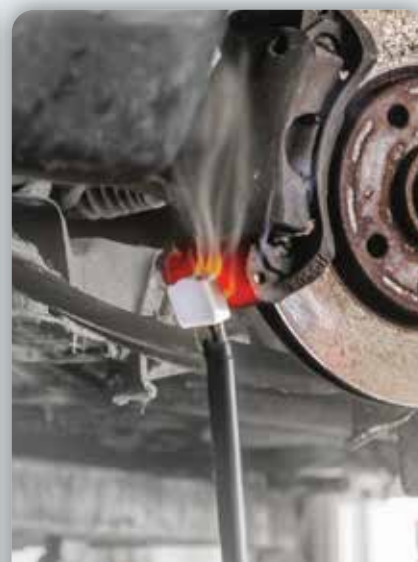
RELEASING BRAKE CALIPER - DÉGRIPPAGE ÉTRIER DE FREIN Inductor S20/B1 Powerduction 39LG
